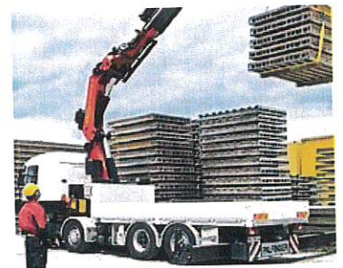
Grue de chargement montée derrière la cabine
